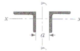
برای هر فاصله  $C_1$  گشتاور ماند اصلی نسبت به محور  $y-y$  بزرگتر از گشتاور اصلی نسبت به محور  $x-x$  میشود.
